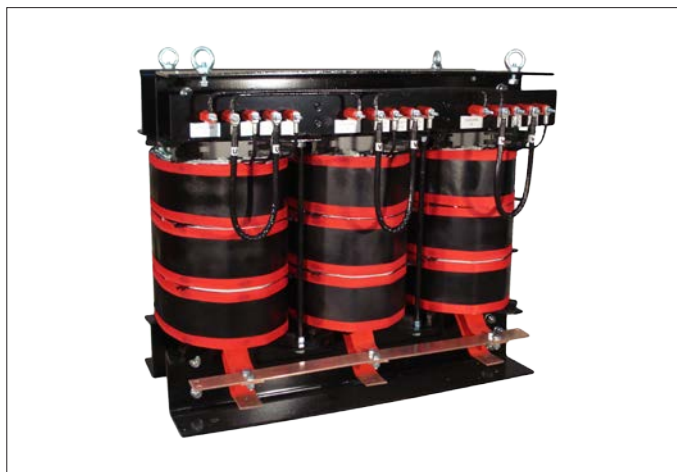
Fot. 1. Transformator przekształtnikowy typu 3TTL przeznaczony do zasilania prostownika sterowanego
